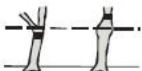
Gambar 2.5 Petunjuk pengukuran diameter atau keliling batang pada berbagai bentuk tegakan
